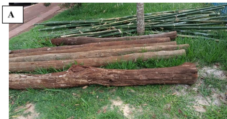
Figura 8 - (A) Bambus e pilares de aroeira e eucalipto. (B) Sapê.
