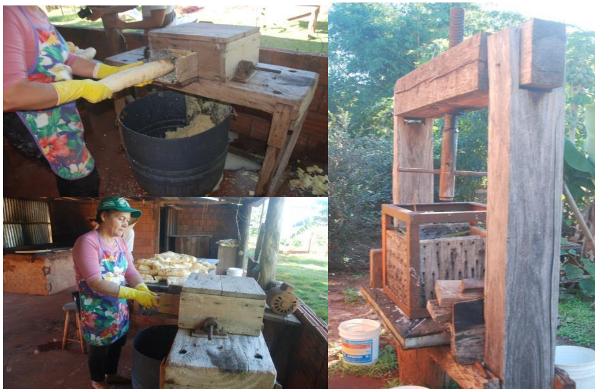
Figura 1. Triturador (a) e prensa (b) utilizada para extrair o polvilho, Sítio Sagrado Coração de Jesus, Assentamento Guanabara, Amambai-MS, 2013
