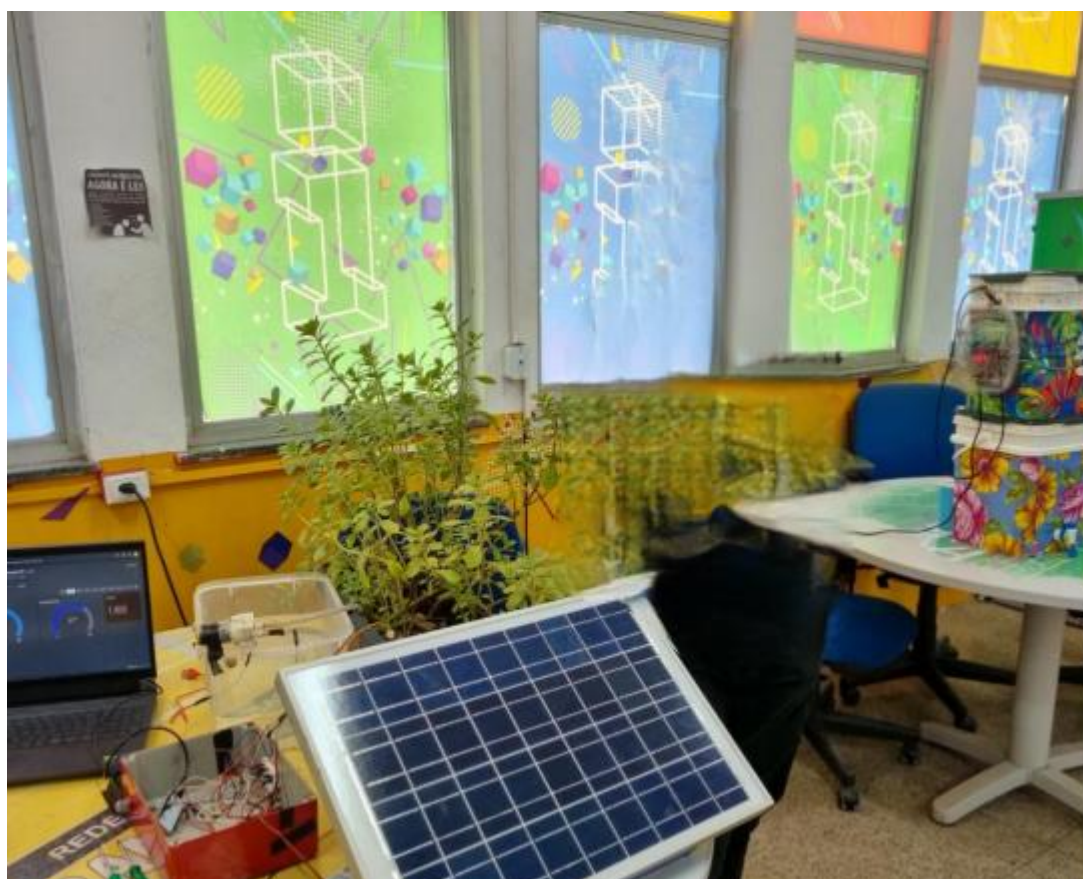
Figura 4 – Automação da irrigação da horta comunitária e do sistema de compostagem da instituição de ensino IEMA Itaqui-Bacanga
