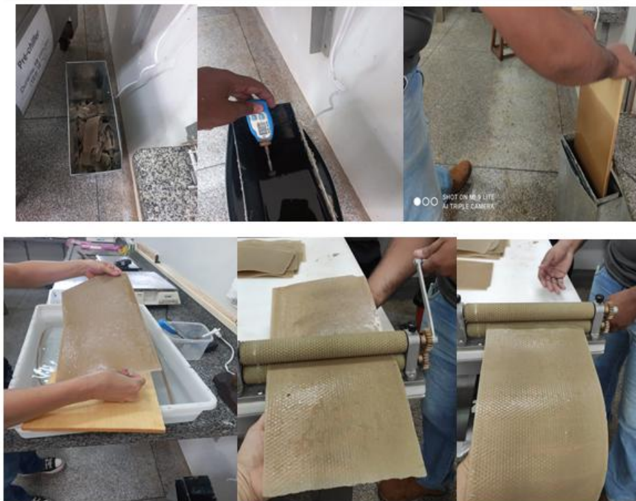
Figura 3. Processamento da cera: Derretimento, laminação e alveolação da cera de abelha.
