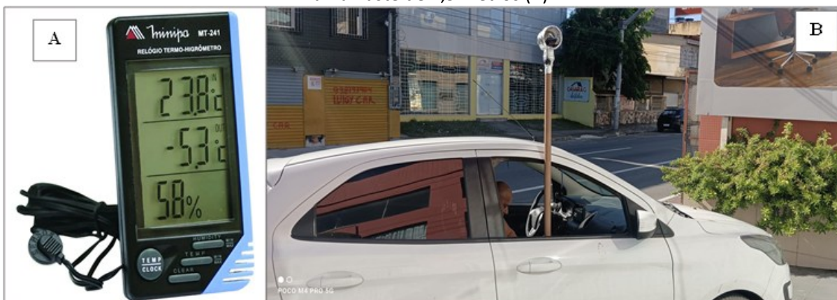
Figura 8 – Termo-higrômetro utilizado em campo (A) e o cano PVC envolto de papel alumínio fixado numa haste de 1,5 metros (B)
