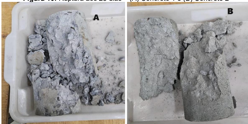
Figura 10: Ruptura aos 28 dias – (A) Concreto 1 e (B) Concreto 2
