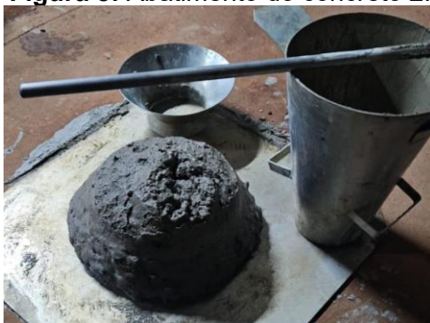
Figura 8: Abatimento do concreto 2.
