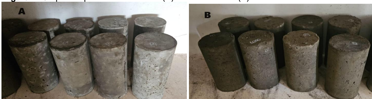
Figura 7: Corpos de prova do concreto 1 (A) e do concreto 2 (B) armazenados na câmara úmida
