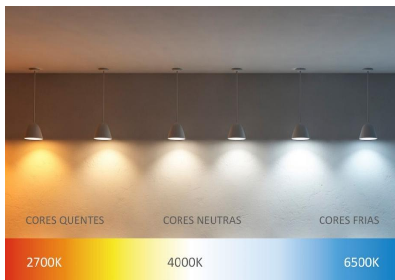
Figura 2 – Temperatura de cor correlata das lâmpadas
