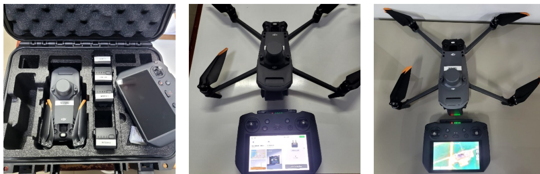
Figura 1. Equipamento (drone) modelo DJI Mavic 3 Multispectral, utilizado na pesquisa de campo.
