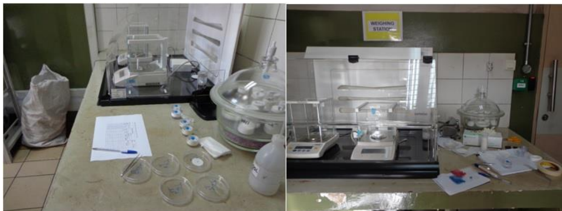
Figura 7 - Determinação da concentração mássica de partículas totais em suspensão
