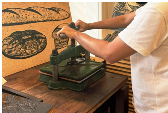
Figura 5 - Uso da prensa de rosca manual para auxiliar na impressão da xilogravura tipográfica.
