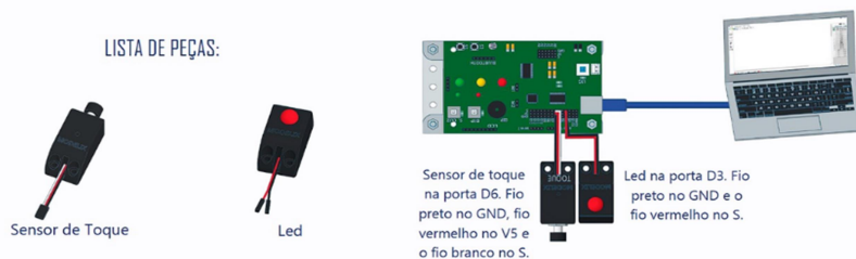
Figura 6 - Acionamento do LED por Sensor de Toque.
