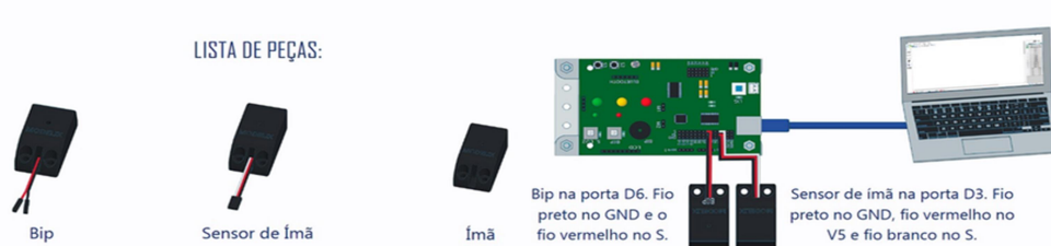
Figura 7 - Acionamento do Bip por Sensor de Ímã.
