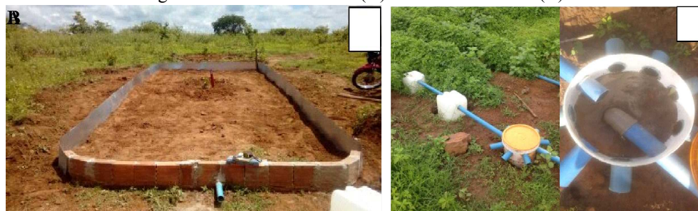
Figura 7 - Parcela de erosão (A) e sistema de coleta (B).
