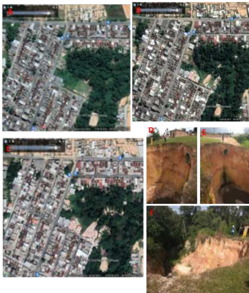
Figura 3. Obra emergencial na rua Salamanca (bairro Nova Cidade). Legenda: a) início da área de risco (junho/2019); b) incisão alcança o leito carroçável (junho/2021); c) início das obras (setembro/2021); e, d/e/f) causa do surgimento (drenagem pluvial). Elaboração Própria.
